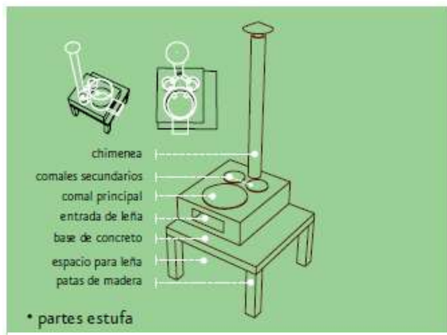
Imagen 6.14. Estufa Lorena. Transferencia de tecnología y divulgación sobre técnicas para el desarrollo humano y forestal sustentable, [25/AGOSTO/2018].
