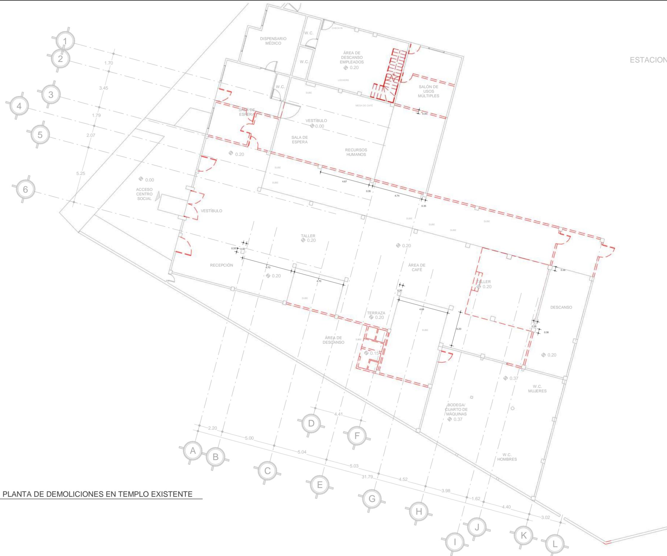
PLANTA DE DEMOLICIONES EN TEMPLO EXISTENTE
