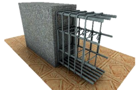
Ilustración 58 corte de trabe de concreto armado
