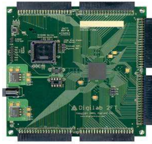
Fig. 4.9 tarjeta de desarrollo con una FPGA Spartan 2E de 400 K compuertas, modelos D2FT de Digilent INC
