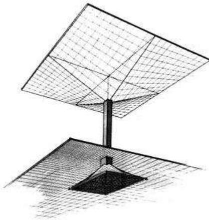
**Fig. 18.** Rejillas para conducir el agua de precipitación pluvial a los mantos freáticos.
