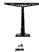
Zapata aislada de concreto armado de 1.30x1.80 m, armada con varillas de  $\frac{1}{2}$  en planta @20 cm, en ambos sentidos  $f_y=4200 \text{ kg/cm}^2$ , concreto de  $f_c=250 \text{ kg/cm}^2$ .
