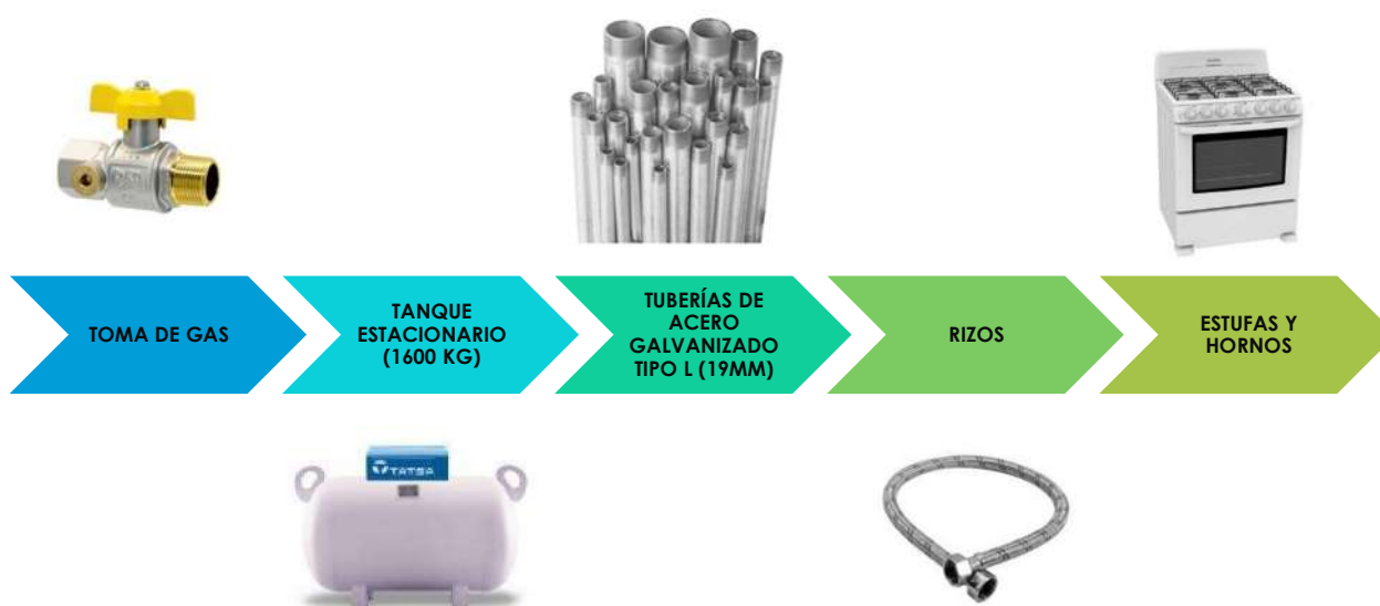
Ilustración 59: : Esquema de Instalación de Gas. Elaboración Propia
