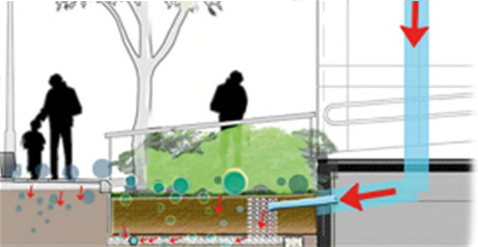
Bajada pluvial, (Instalación hidráulica)
