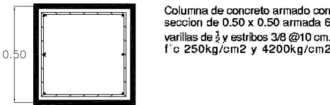
Columna de concreto armado con seccion de 0.30 x 0.30 armada 6 varillas de 3 y estribos 3/8 @10 cm. f'c 250kg/cm2 y 4200kg/cm2
