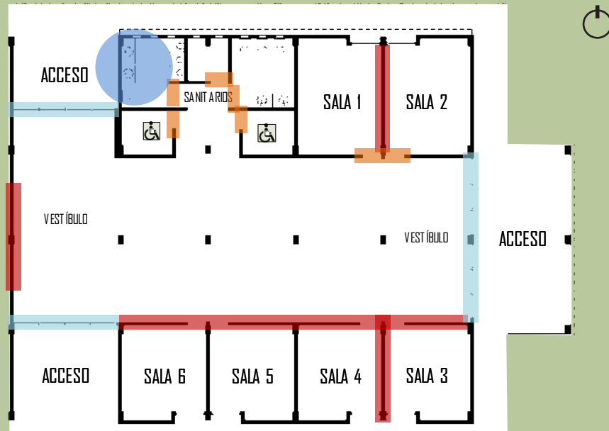
Figuras 65. Plano de demolición. Elaboración propia.
