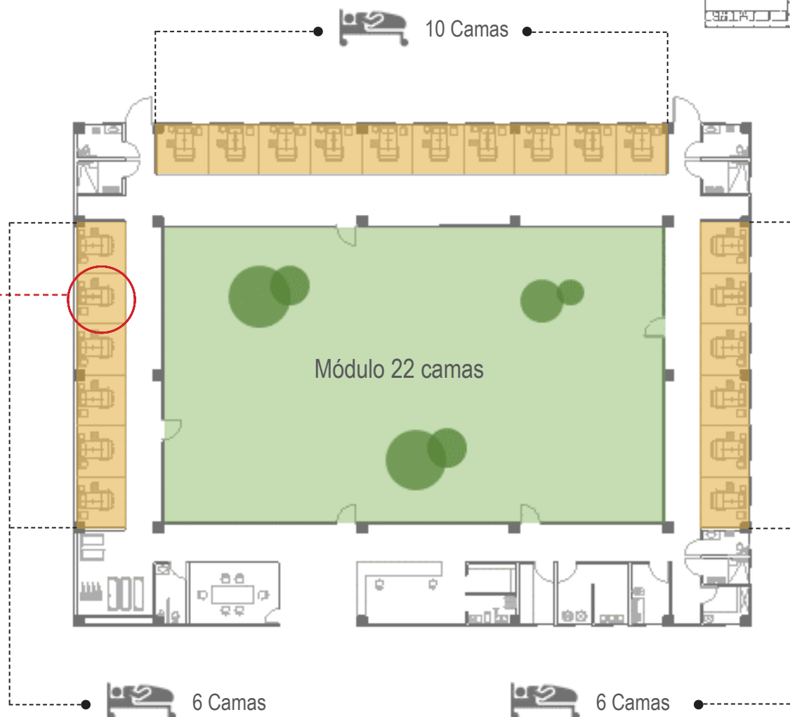
Figura 156. Diagrama de distribución total de camas del área de hospitalización (Encamados) IMSS Camelinas Autor MAAC.
