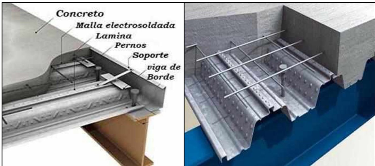
Imagen. 37 Detalle constructivo de una losa de concreto.
