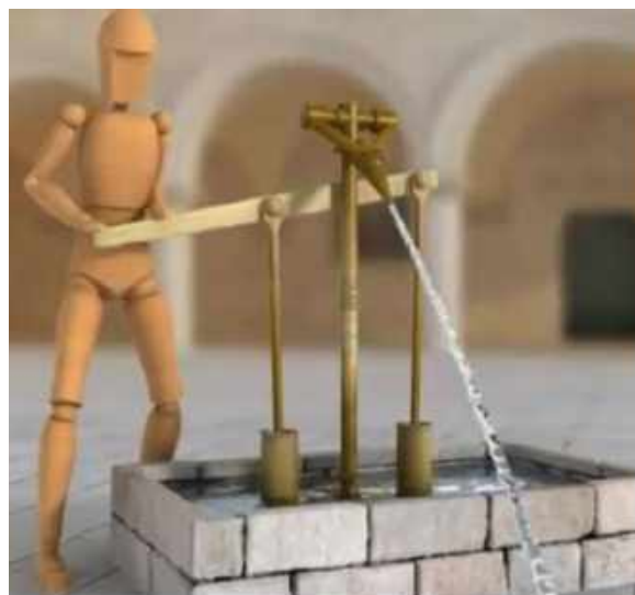
Bomba de Ctesibio-Herón montada en pozo
