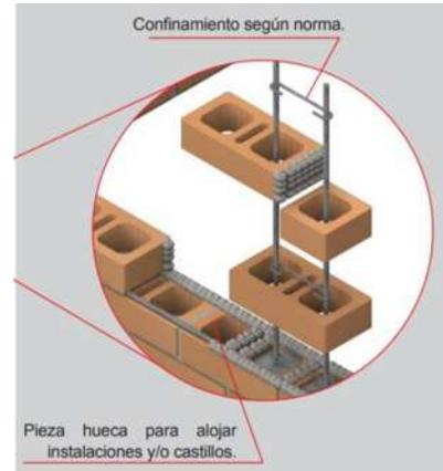
Fig. 107 Block extruido. Novaceramic.
