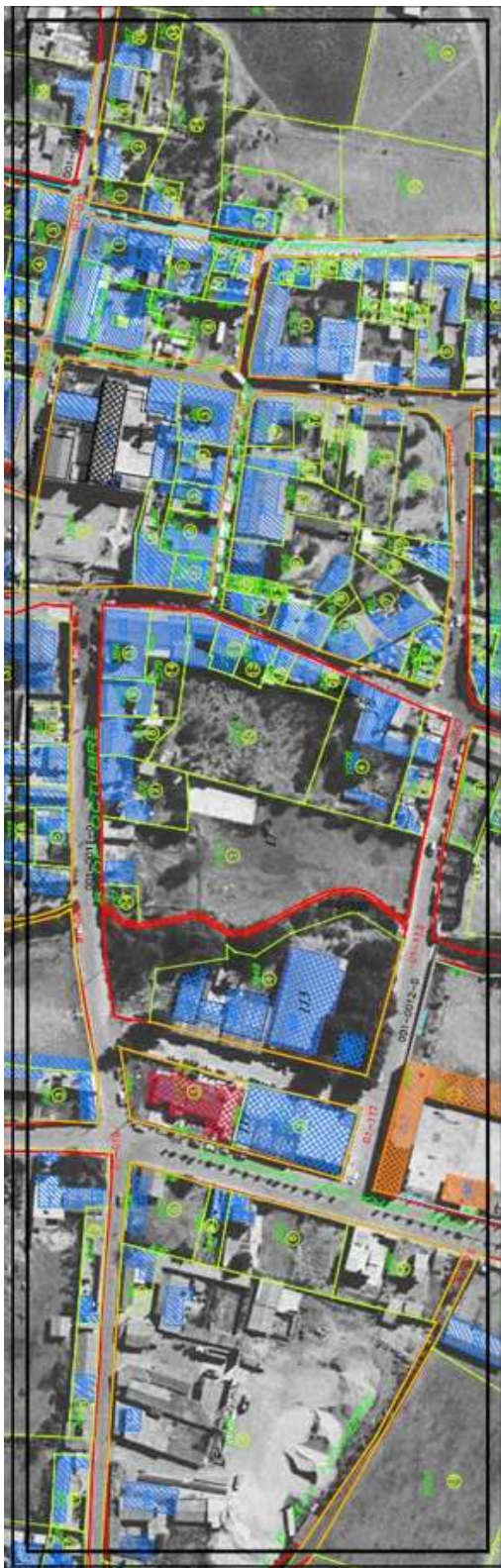
Ilustración 80. Representación de la zona del empate, entre las Ortófotos del año 2002, así como la digitalización de carpetas manzaneras en conaflex del año 1994, con la unión de la Cartografía vectorial a nivel manzana 2007. En esta imagen se percibe el ejemplo de los faltantes de omisiones representada con un el círculo de color rojo; de construcciones y predios no actualizados en los padrones catastrales y por ende en lo fiscal.
