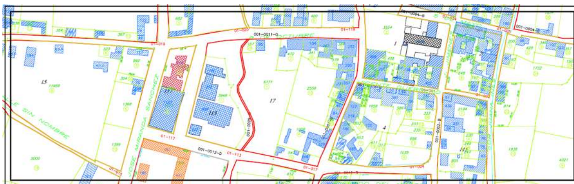
Ilustración 79. Representación de una zona del empate, entre la digitalización de carpetas manzanas en conaflex y cartografía vectorial a nivel manzana de la Cabecera Municipal llamada “San Bartolo Morelos”.
