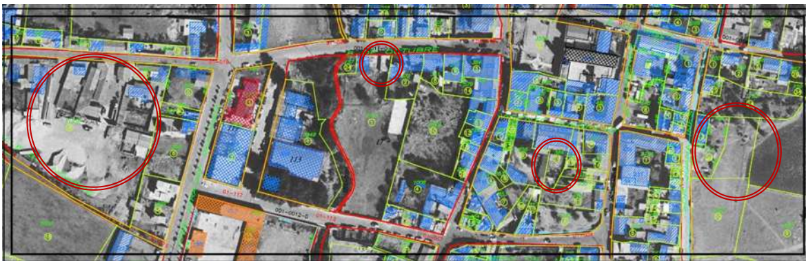
Ilustración 80. Representación de la zona del empate, entre las Ortófotos del año 2002, así como la digitalización de carpetas manzanas en conaflex del año 1994, con la unión de la Cartografía vectorial a nivel manzana 2007. En esta imagen se percibe el ejemplo de los faltantes de omisiones representada con un el círculo de color rojo; de construcciones y predios no actualizados en los padrones catastrales y por ende en lo fiscal.
