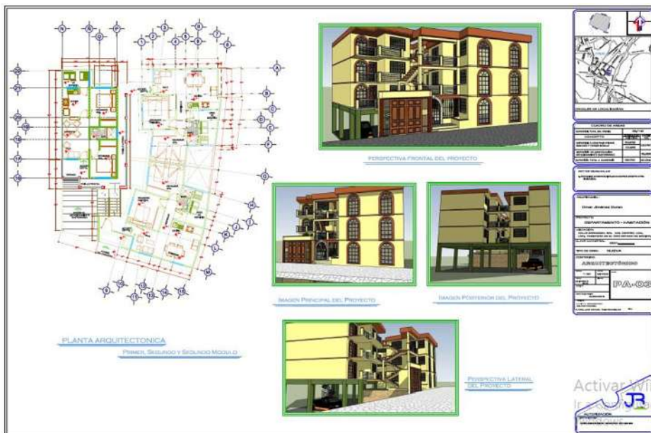
Ilustración 103. Imagen del plano del conjunto, donde se representan las plantas de los tres módulos en serie, para dar como resultado 9 departamentos. También se muestran Perspectivas en 3D de las diferentes vistas, donde se percibe la parte posterior, frontal y lateral, percibiéndose los cuatro niveles, así como los tres de departamentos y el espacio del estacionamiento Subterráneo.
