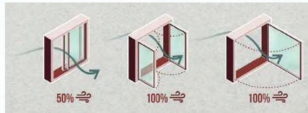
Imagen 70. Apertura de ventanas
