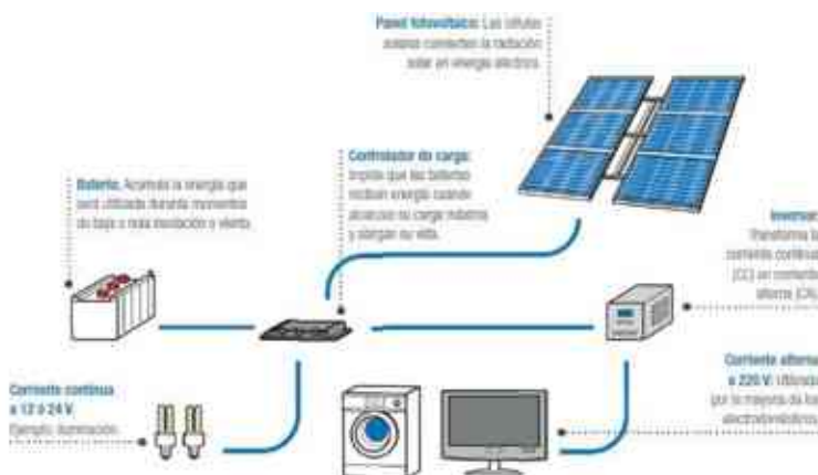
Imagen 30: Diagrama de funcionamiento de celda fotovoltaica, Fuente: https://ovacen.com/garantia-placas-solares-fotovoltaicas/ , 10-Ago-2020.
