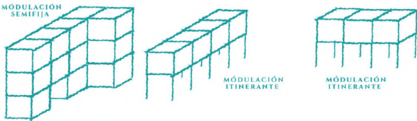
Ilustración 142. Modulación estructural. Elaboración propia.
