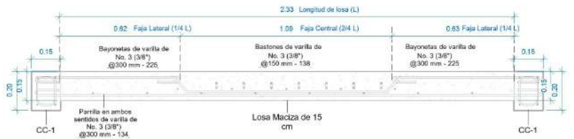
2 Corte Losa 1 1 : 10
