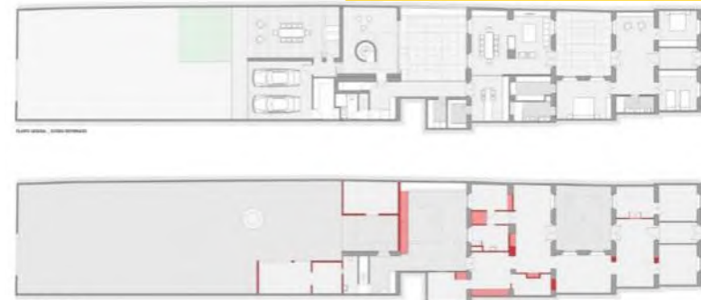
Fig. 1.52. Arriba plano de remodelación, abajo, plano original donde se señalan los muros a derribar. Fuente: Despacho de arquitectura Seza
