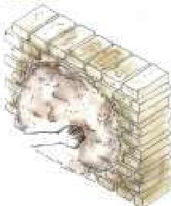
Colocar la mezcla de barro y paja de manera rústica en el muro. Hacer bolas de mezcla y apretarla con fuerza en la pared.
