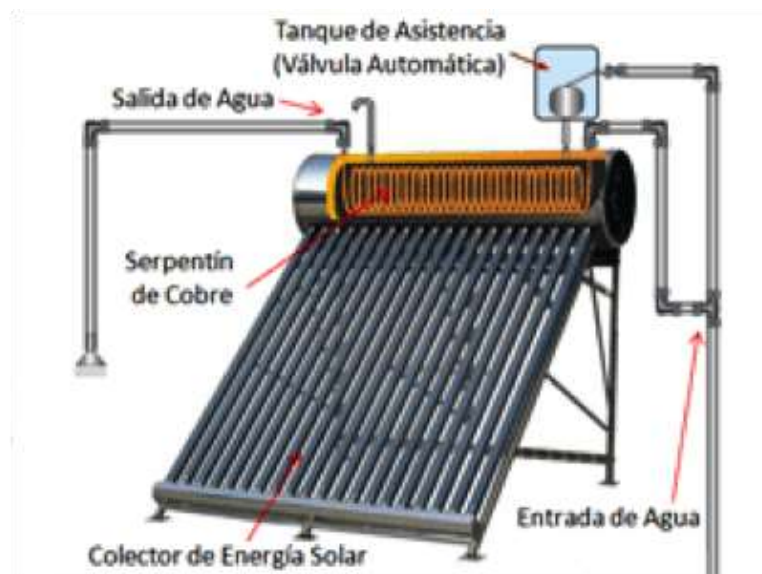
Imagen 12-1. Sistema de captación de agua.
