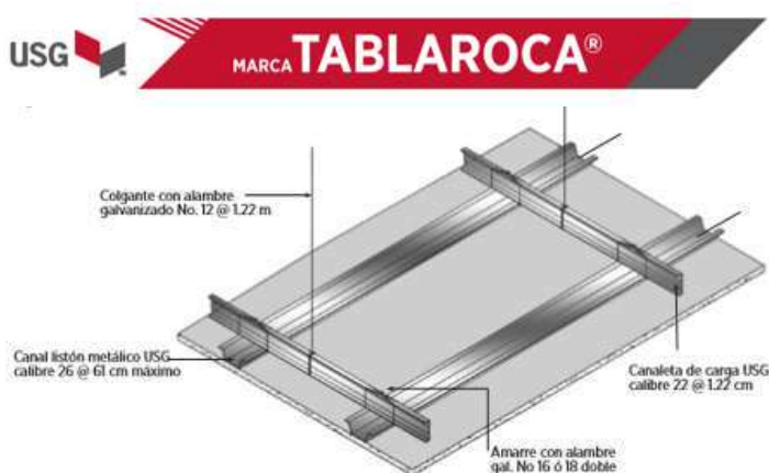
Figura 97. Sistema de cielo corrido, consultar ficha técnica
