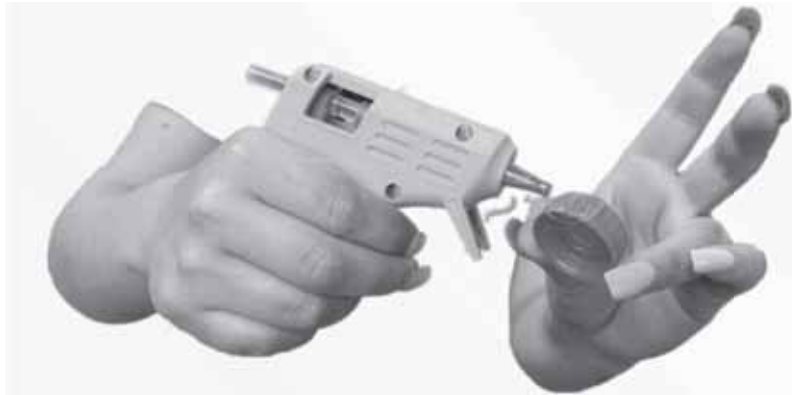
Fig. 3.2.2.1 Colocar el pegamento caliente en la taparrosca para así poder unirla con la siguiente, Ruth Esmeralda Segovia Trejo
