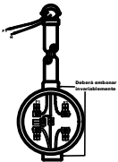
DETALLE MEDIDOR E INTERRUPTOR DE NAVAJAS
