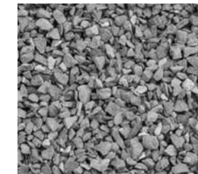
GRAVA Dimensiones Ancho: 5-20mm Espesor: 5-20mm Peso: 75kg/m 2
