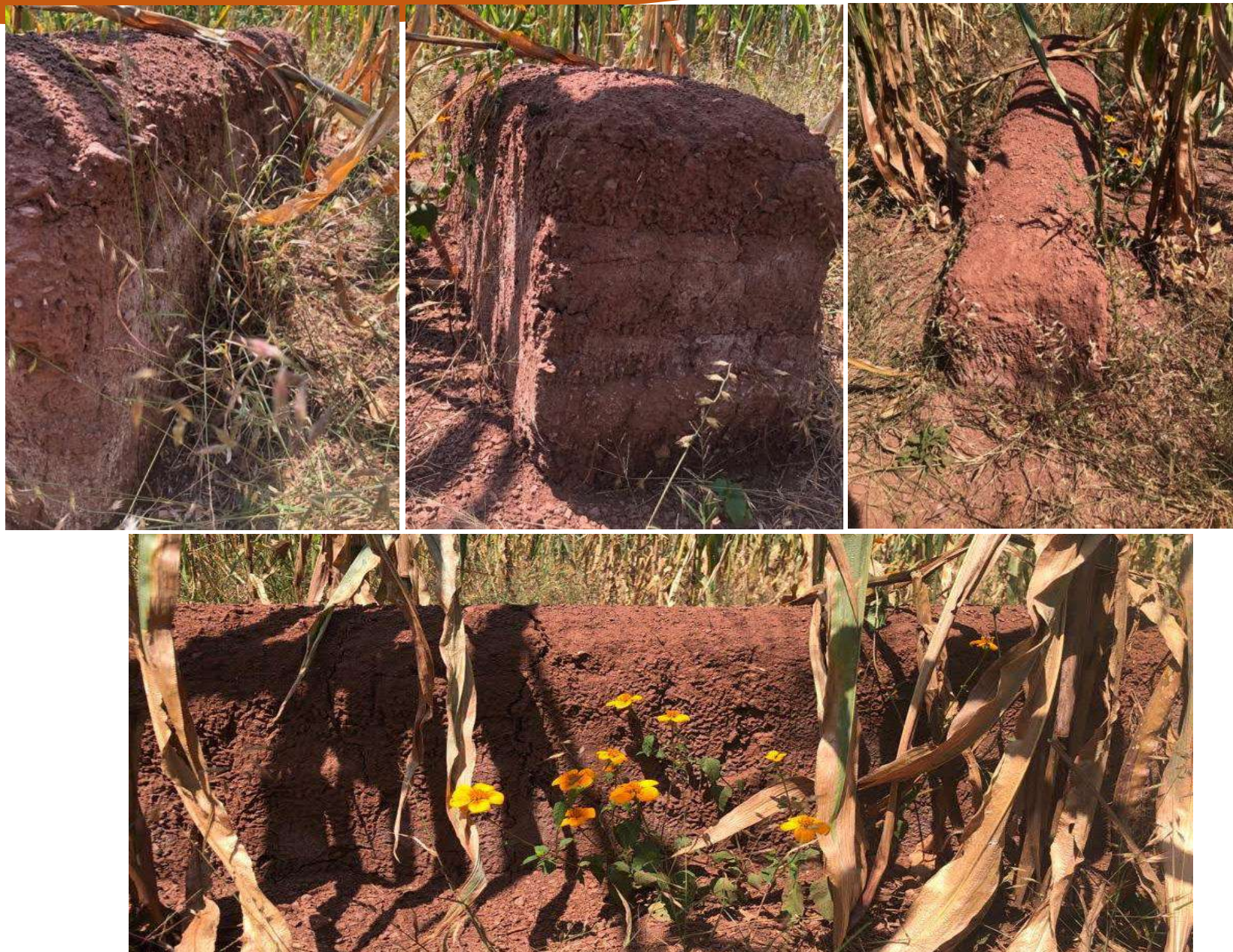
Ilustración 98 Estado del muro 07 meses después. Fotografías de Liz
