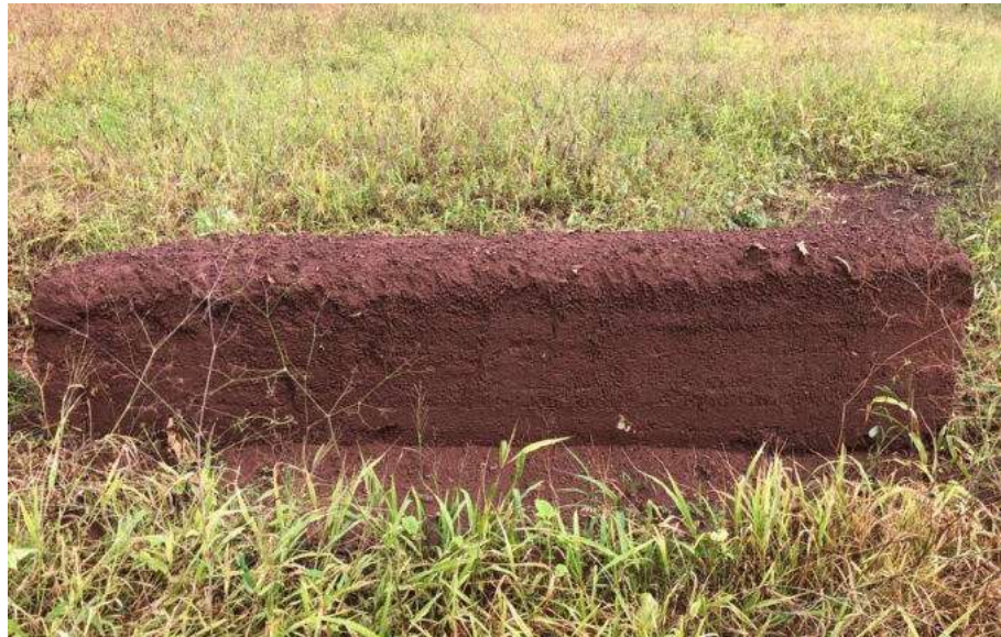
Ilustración 96 Estado del muro 11 semanas después. Fotografías de Liz
