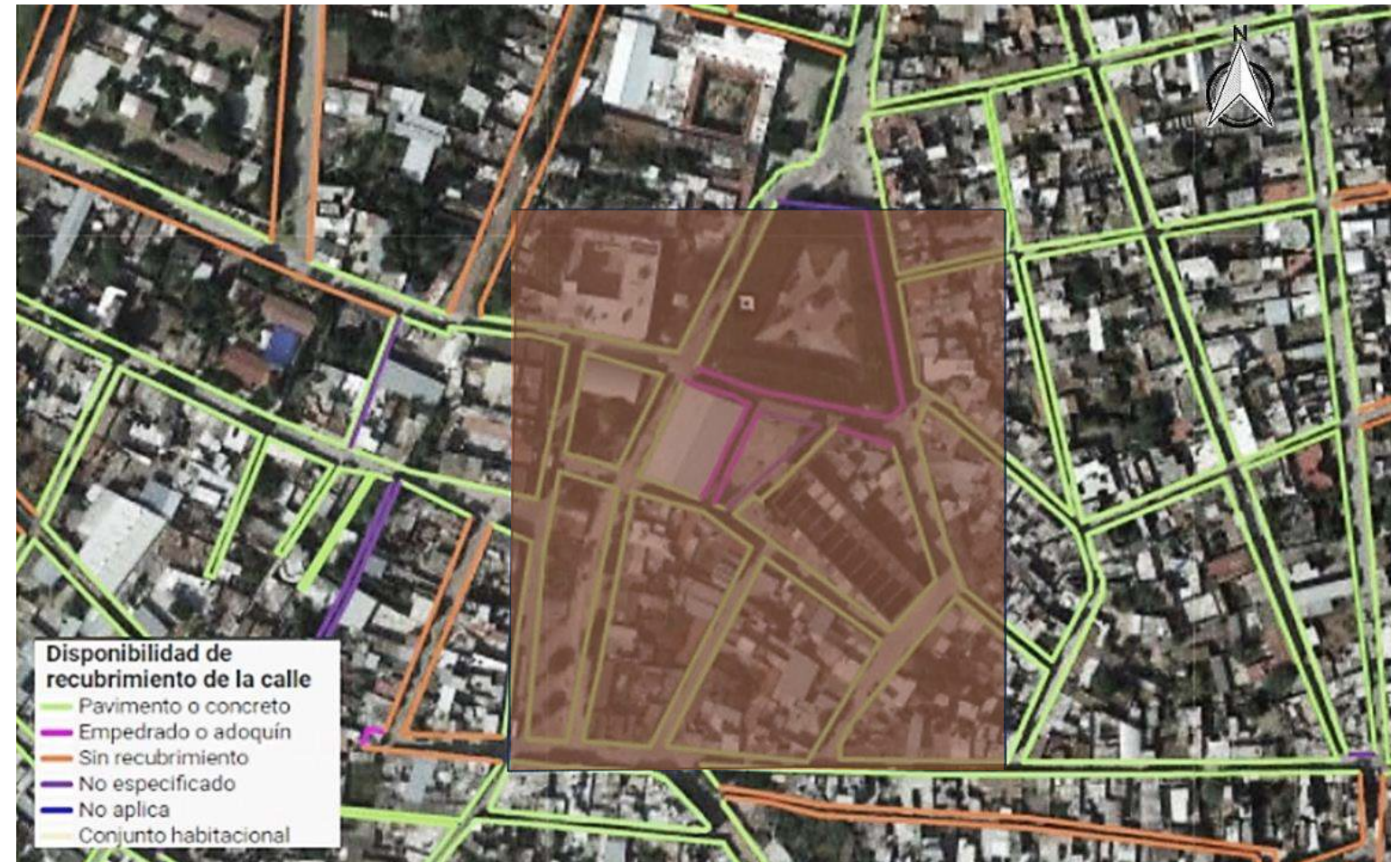
Figura 19. Recubrimiento en calles del área de estudio. Fuente: www.inegi.org.mx
