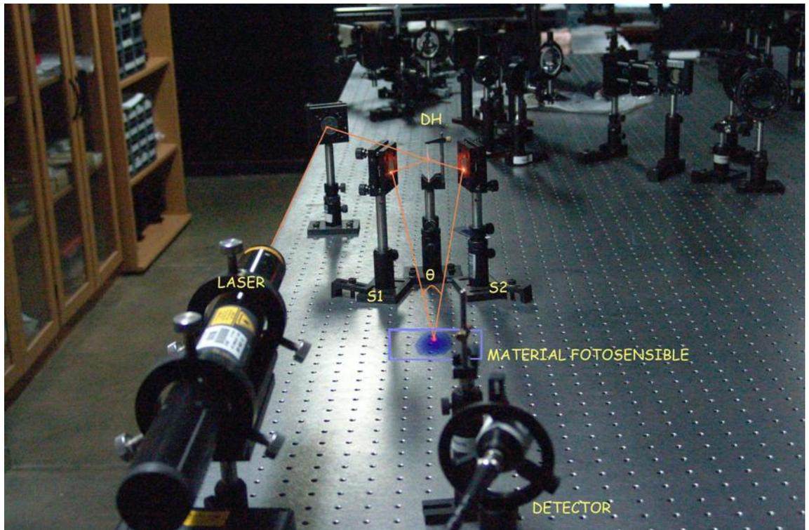
Figura 4.3: Fotografía del arreglo para grabar rejillas holográficas en el laboratorio de óptica
