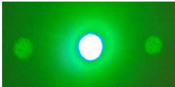
Figura 4.8: Patrón de difracción de una rejilla holográfica grabada en la emulsión de PVA y VG.
