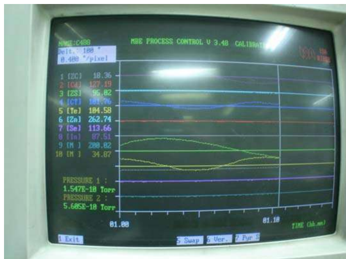
Figura 3.17 Monitoreo de la temperatura para las diez celdas de efusión del sistema MBE Riber 32P del NanoSem
