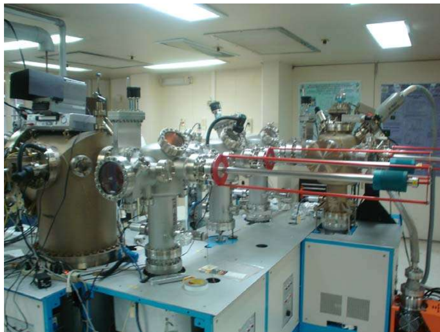
Figura 3.11 Fotografía del sistema MBE Riber 32P del grupo NanoSem empleado en nuestros crecimientos.
