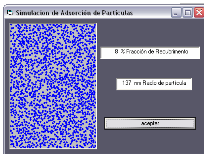
Figura 12. Simulación de partículas adsorbidas hecha en Microsoft Visual Basic ® , para el caso en que el porcentaje de la fracción de recubrimiento es 8% y el radio de la partícula 137nm.
