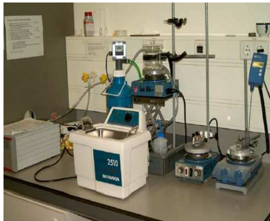
Figura 4.21: Tina de lavado ultrasónico empleada para disolver el C_{60} .
