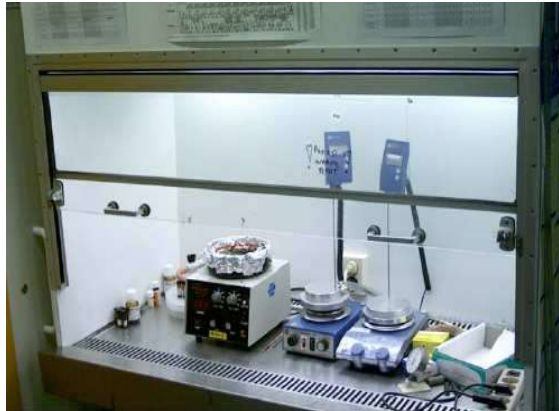
Figura 4.22: Instrumento utilizado para formar películas delgadas mediante la técnica de centrifugado.
