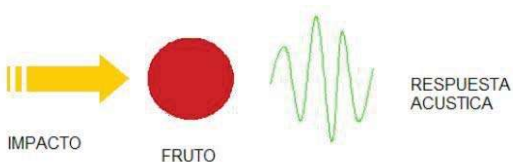
Figura 4.1: Representación gráfica del modelo teórico propuesto para predecir las frecuencias de resonancia características de la respuesta acústica típica de frutos sometidos a un impacto acústico.
