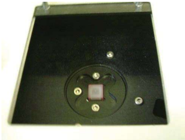
Figura II.7 Celda contenedora de la muestra preparada colocada en el DTP para su análisis.
