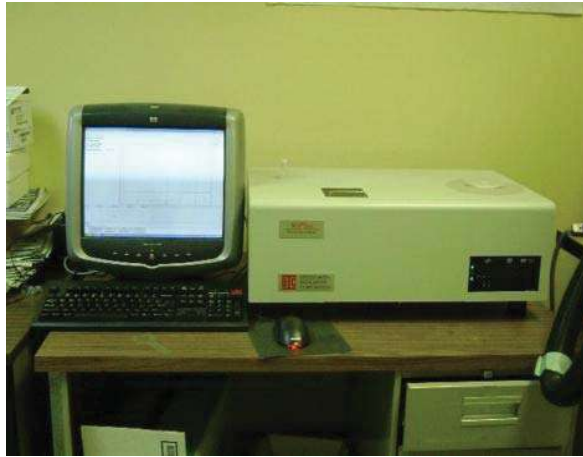
Figura II.6 DTP de la marca Brookhaven con el que se hizo el análisis de tamaño de partícula.
