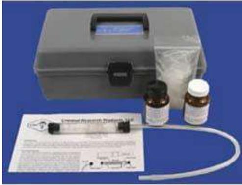
Figura 10. Equipo para implementación de revelado por vapores de yodo.
