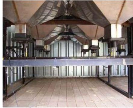
(b) Fotografía de los distintos módulos de cada estación. Se aprecian en la parte inferior de los módulos con forma piramidal, los fotomultiplicadores con los que cada módulo cuenta.
