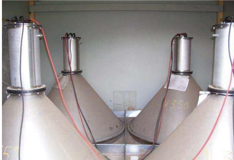
(a) Dentro de cada estación  $e/\gamma$  de KASCADE se encuentran cuatro colectores de luz como los que se muestran en la presente figura.
