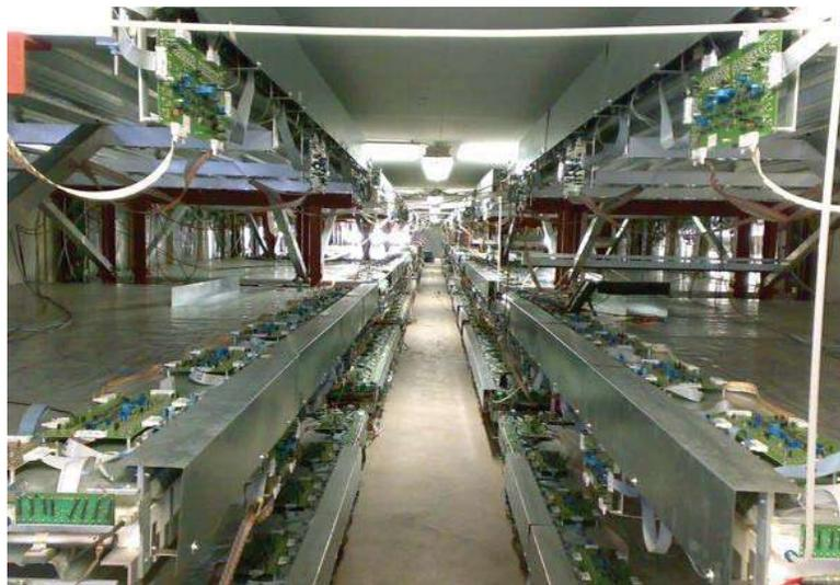
(b) Imagen que muestra el MTD de KASCADE desde su interior. Se puede apreciar parte de la electrónica que conforma al aparato.
