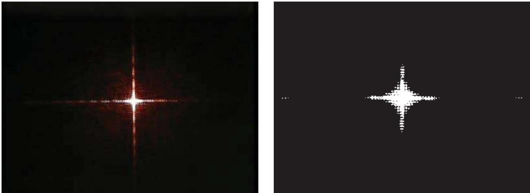
Figura 5.6: Imagen de los planos de frecuencias obtenidos mediante el arreglo de laboratorio (izquierda) y mediante el algoritmo rápido para la TCL (derecha).
