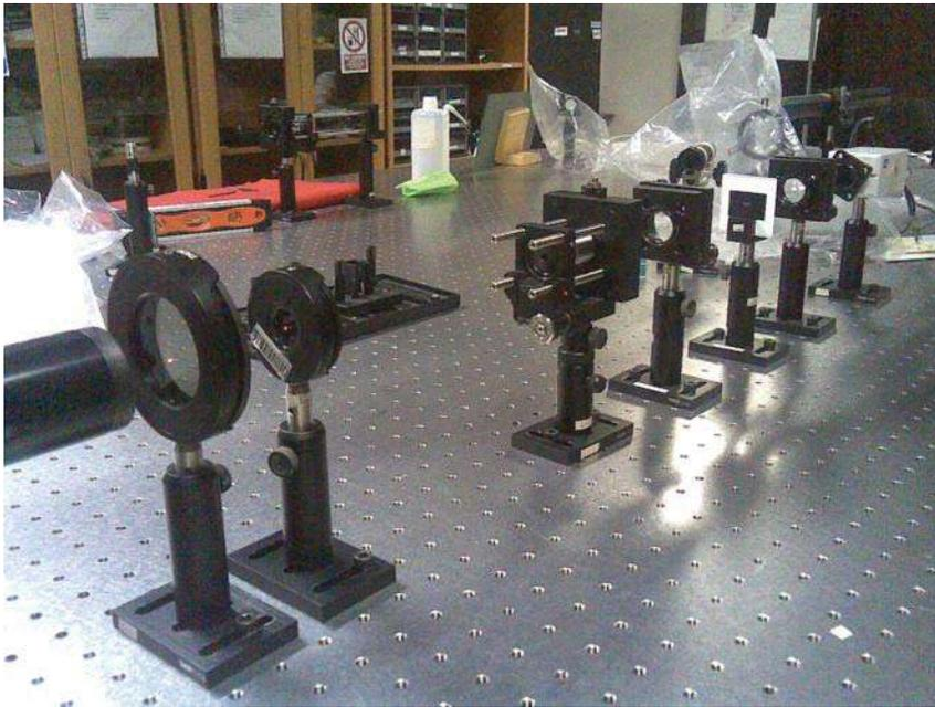
Figura 5.4: Imagen del arreglo utilizado para transformar los objetos en el Laboratorio de Holografía.
