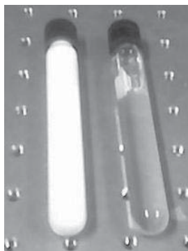
Figura 3.2. Fotografía de las muestra inicial y diluída al 0.0125% de partículas de látex de 936 nm .
