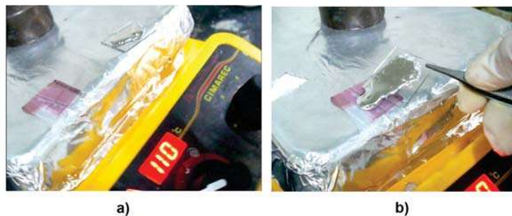
Figura 3.8: Deposición del Wood's metal. a) Se deja calentar la aleación a una temperatura mayor a 75^{\circ}\text{C} , al igual que la celda donde se hará el depósito, b) Se deposita el Wood's metal directamente en el área activa de la celda y posteriormente se retira de la parrilla para que la aleación se solidifique.
