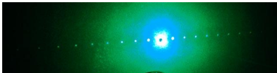
Fig. 4.16. Fotografía del HPDLC después de que se grabó la rejilla con voltaje con el láser de argón (514 nm).
