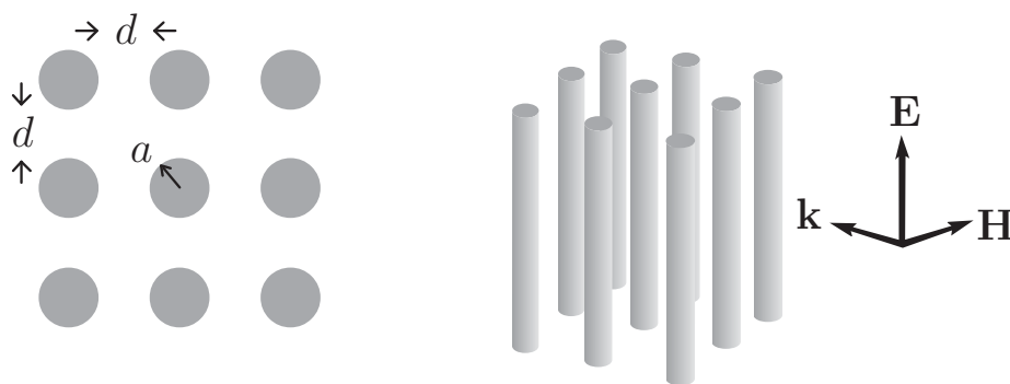
Figura 6. Metamaterial compuesto de tubos de metal con el que es posible obtener una respuesta eléctrica negativa.
