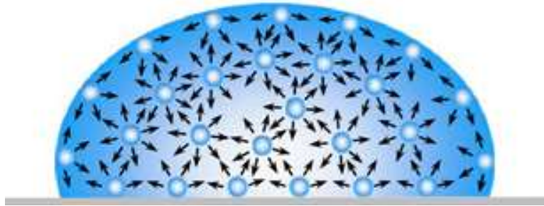
Figura 2.1: La tensión superficial es causada por el desequilibrio de fuerzas en las moléculas de la superficie, Yuan y Lee (2013).
