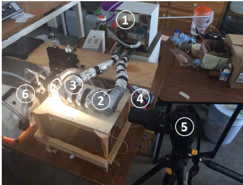
Figura 3.8: Arreglo experimental y sus componentes, para medidas de ángulo de contacto controlando la temperatura con un baño térmico.
