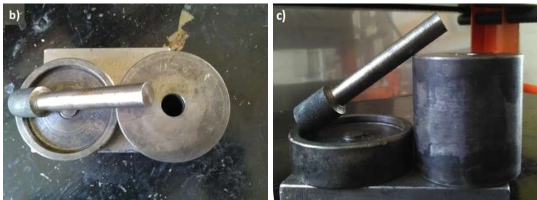
Figura 3.6: a) Prensa y dado b) vista superior y c) vista lateral del dado utilizado para la elaboración de los comprimidos.
