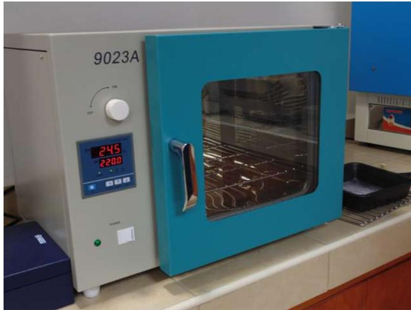
**Figura 4.2:** Horno en el cual se llevaron a cabo los tratamientos térmicos.
