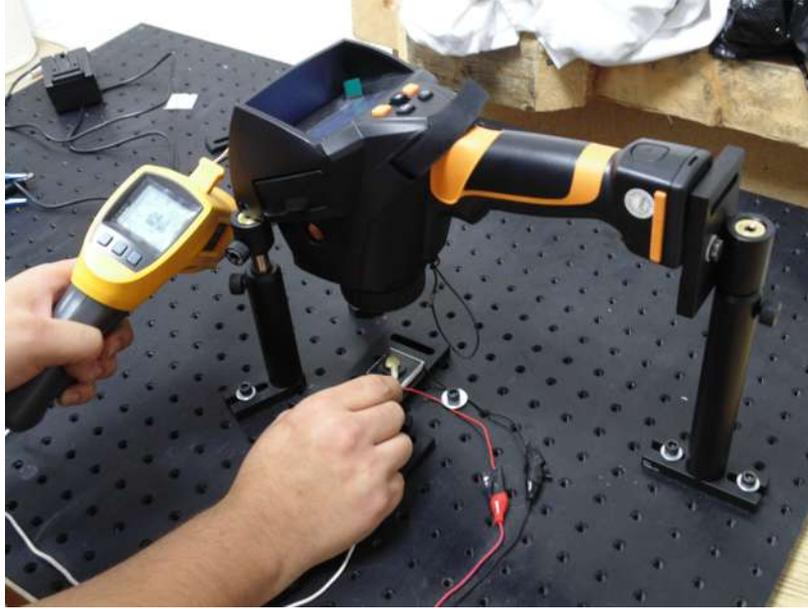
**Figura 4.6:** Procedimiento para realizar la calibración térmica
