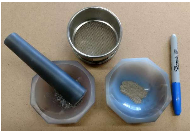
Figura 4.8. Pulverizando. Pequeños trozos de las muestras de roca se pulverizan con ayuda de un mortero y posteriormente son tamizadas para lograr un tamaño uniforme de las partículas.
