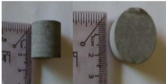
Figura 4.3 Detalles de los núcleos paleomagnéticos estándar para la realización de los experimentos de rocas.
