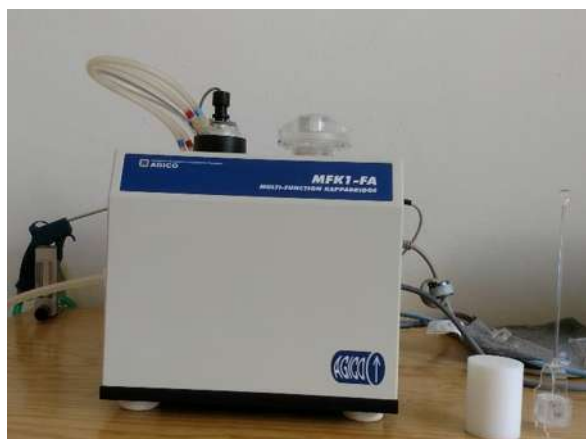
Figura 4.9 Susceptibilímetro marca AGICO modelo MFK1 utilizado para obtener las curvas termomagnéticas k-T.
