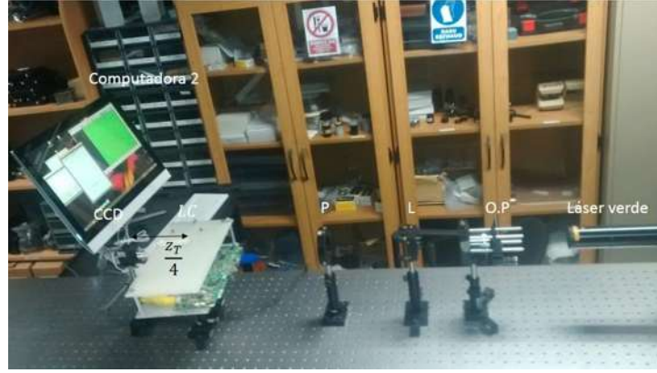
Figura 5.18: Arreglo experimental utilizado en laboratorio, donde O.P es el objetivo de microscopio y P el pinhole, L la lente, P el polarizador, LC el cristal líquido y la CCD la cámara que captura la imagen a una distancia z de la LC.
