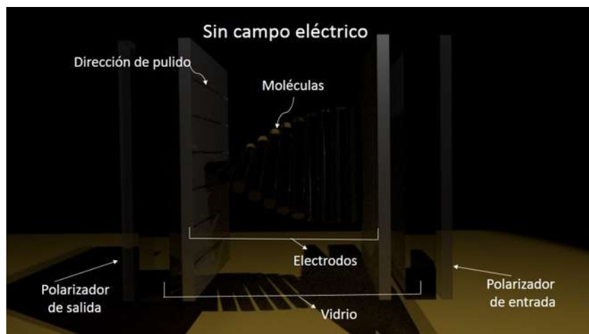
Figura 3.3: Componentes y funcionamiento de una TN-LCD de TFT.
