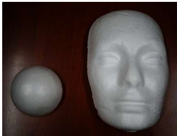
Figura 6.3: Fotografía de los objetos estudiados que consiste en un rostro de unicel con medidas de 12.4 cm de ancho, 19 cm de largo y una semiesfera del mismo material de radio 3.8 cm.
