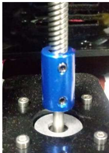
Figura 5.12: Impresora 3D: Se muestra una de las tuercas que mueve la cama en dirección z.
