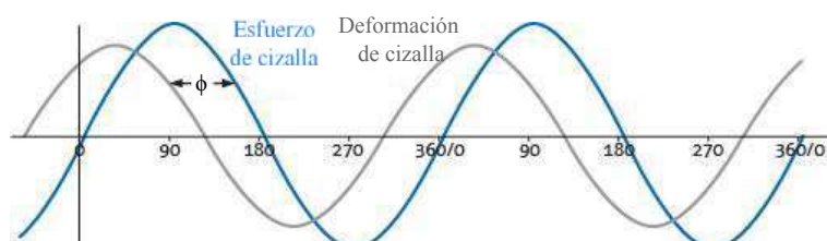
FIGURA 4.8: Curvas del esfuerzo y la deformación de cizallamiento durante un experimento típico.
