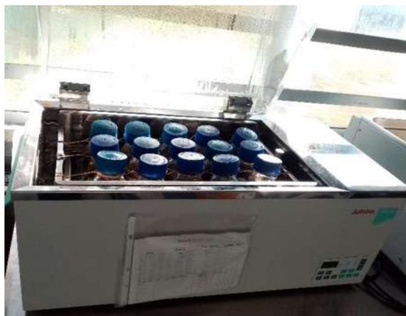
Figura 6. Sacarificación en frascos de rosca para llevar a fermentación
