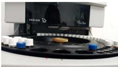
Figura 9. Carrusel del cromatógrafo
