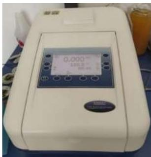
Figura 10. Espectrofotómetro utilizado para medir densidad óptica y lignina soluble
