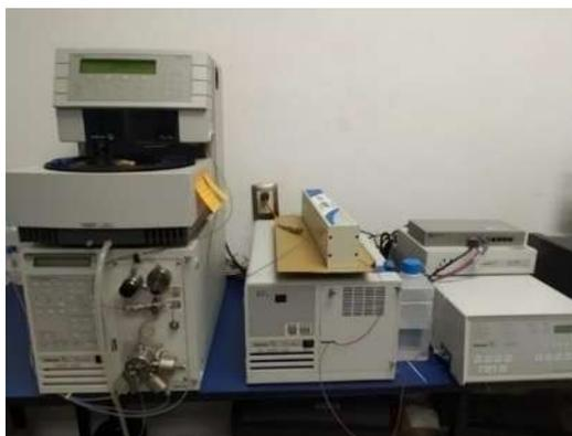
Figura 7. Cromatógrafo de líquidos Varían ProStar 410
