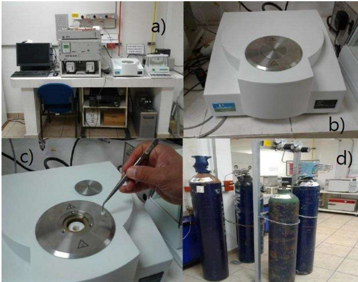
Figura 11. a) Equipo analizador TGA-DTG; b) Analizador termogravimétrico PerkinElmer STA 6000; c) Crisol para colocación de la muestra; Tanques de oxígeno y nitrógeno.
