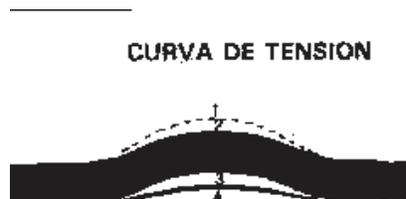
**Figura17.** Curvas de tensión que permiten a la malla una elasticidad que permite mantener el acero en tensión.
