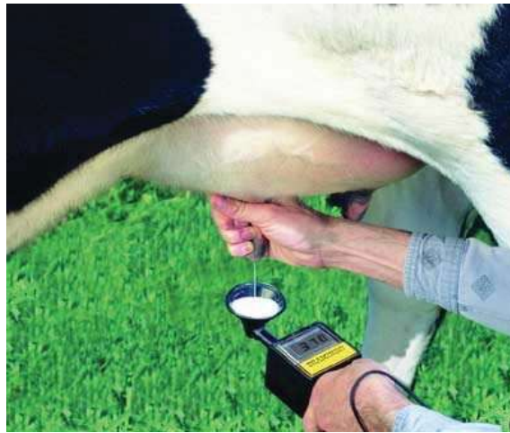
Figura 4. Aparato para determinación de la conductividad eléctrica de la leche
