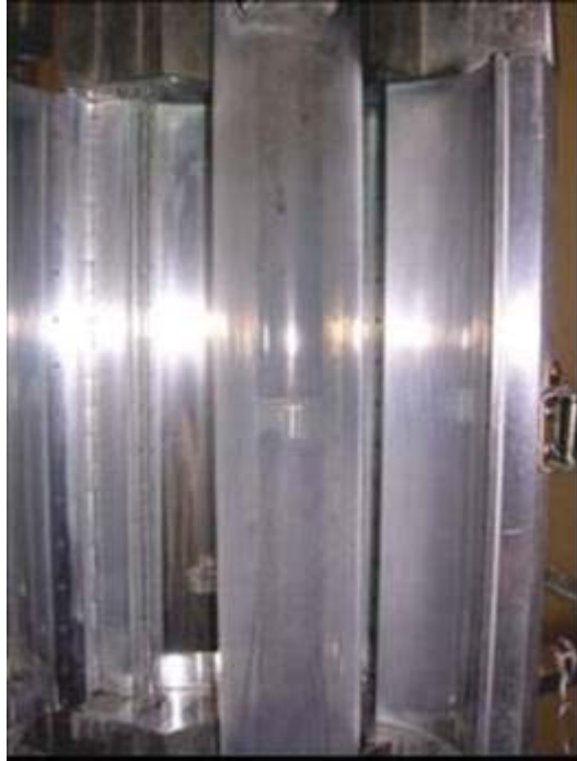
Figura 2.9. Montaje de las mordazas protegidas por un tubo de cuarzo, probeta y horno de radiación en la máquina Instron.
