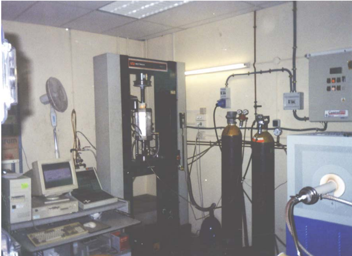
Figura. 2.3. Sistema de ensayos mecánicos a altas temperaturas.
